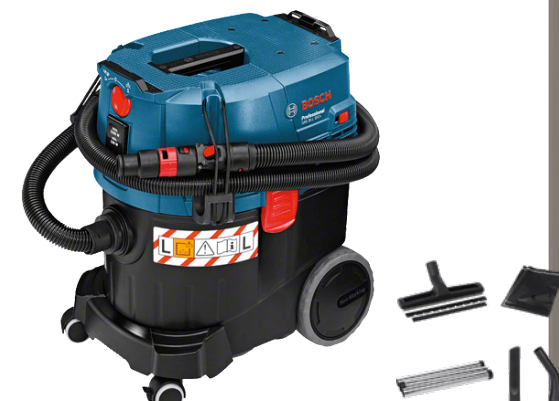
STOFZUIGER GAS 35 L SFC+ VOOR WATER EN STOF 1.200W. Luchtdebiet 74 L/sec. Tankcapaciteit 35L. Zuigkracht: 254 mbar. Met toebehoren. 06019C30W0 - 306516/D
